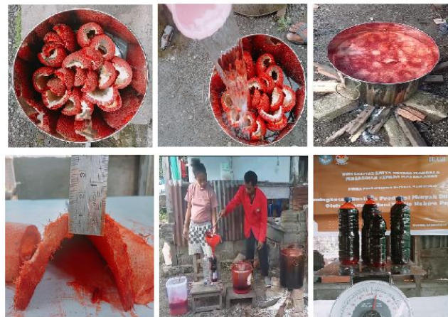
Gambar 4. Proses perebusan , pemisahan daging buah dan pemisahan minyak
